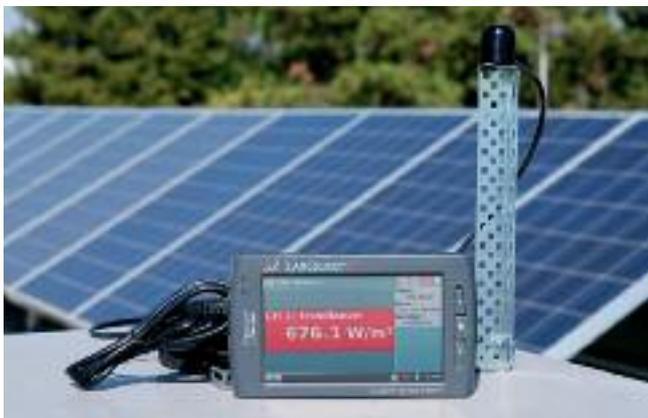
Le capteur a été conçu pour être laissé dehors, il est en outre étanche et peut être plongé dans l'eau (sauf la boîte contenant l'électronique).
