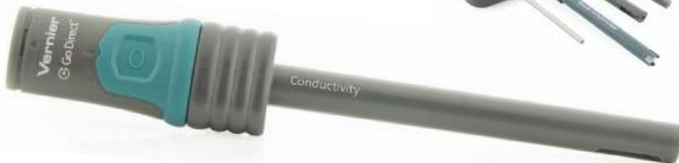
On peut notamment mesurer le contenu ionique d'une solution aqueuse.
