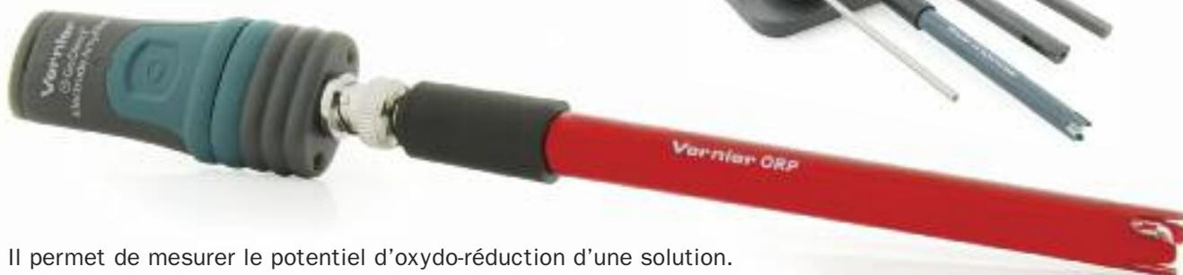
Il permet de mesurer le potentiel d'oxydo-réduction d'une solution.
