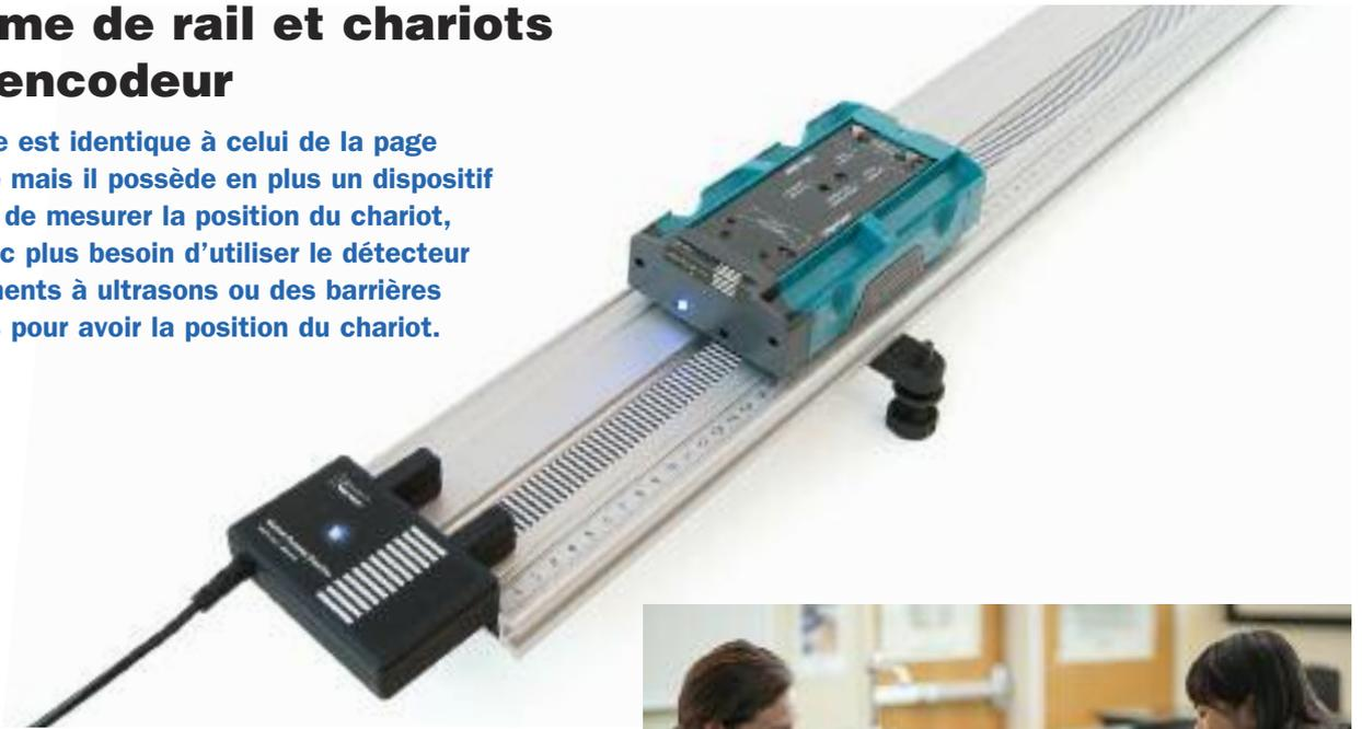
La mesure de position se fait par un système optique et la transmission par infra rouges. Il n'y a donc pas de fils qui gênent le mouvement, et on obtient facilement des mesures précises et répétables même pour les vitesses et accélérations obtenues par calcul à partir de la position.
