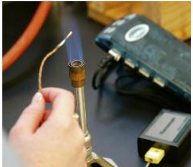
On peut ainsi mesurer la température d'azote liquide aussi bien que de flammes à plus de 1000 °C.
