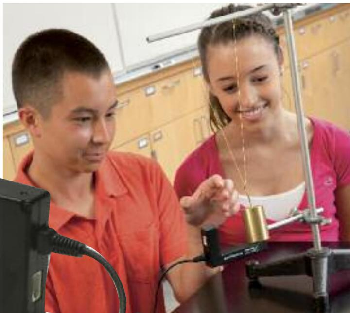
Elle contient en plus un détecteur sur le côté extérieur ce qui permet de créer une barrière de grande largeur. Elle est fournie avec une tige et peut être facilement montée sur un pied. On peut chaîner jusqu'à 4 détecteurs.
