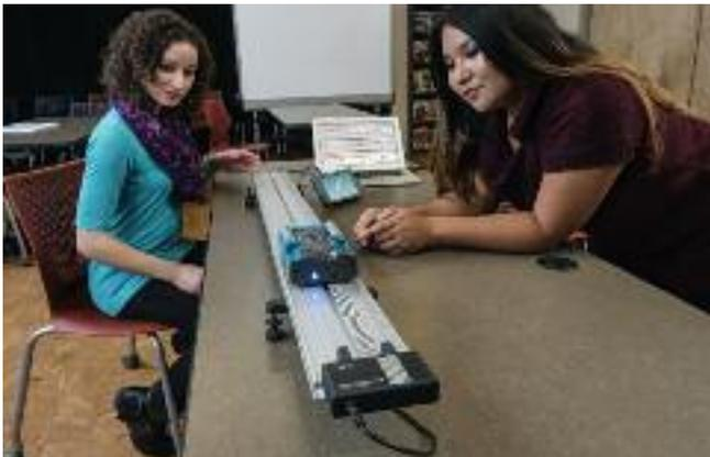
Comme la position est transmise par un faisceau infra rouge étroit, il est possible d'utiliser 2 chariots sur un même rail.
