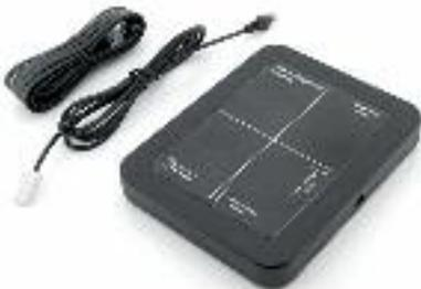
L'accessoire d'indépendance du mouvement permet de lâcher une bille sans vitesse horizontale initiale, à l'instant exact où le lanceur lance une autre bille. On peut ainsi vérifier que les 2 billes touchent le sol en même temps.
