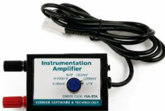
Beaucoup d'appareils de laboratoire fournissent une tension de sortie de faible amplitude qui peut être amplifiée avec cet amplificateur pour pouvoir être enregistrée par l'interface. Par exemple, cet amplificateur permet d'utiliser un spectrophotomètre ou un chromatographe.
